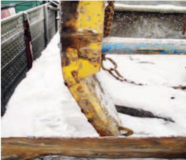
Rys. 3. Widoczne odgięcie dolnej krawędzi boksu
